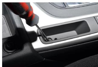
Originele schroef losdraaien
